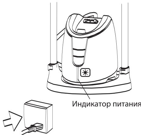
**ШАГ 3.** Нажмите на кнопку включения/выключения питания на корпусе, чтобы включить прибор. Короткий звуковой сигнал оповестит, что прибор включен. На дисплее загорится значок или в зависимости от того, на какой режим вы установите переключатель на ручке утюжка-отпаривателя. Световой индикатор будет гореть красным в режиме сухой гладжки, голубым — в режиме отпаривания.
